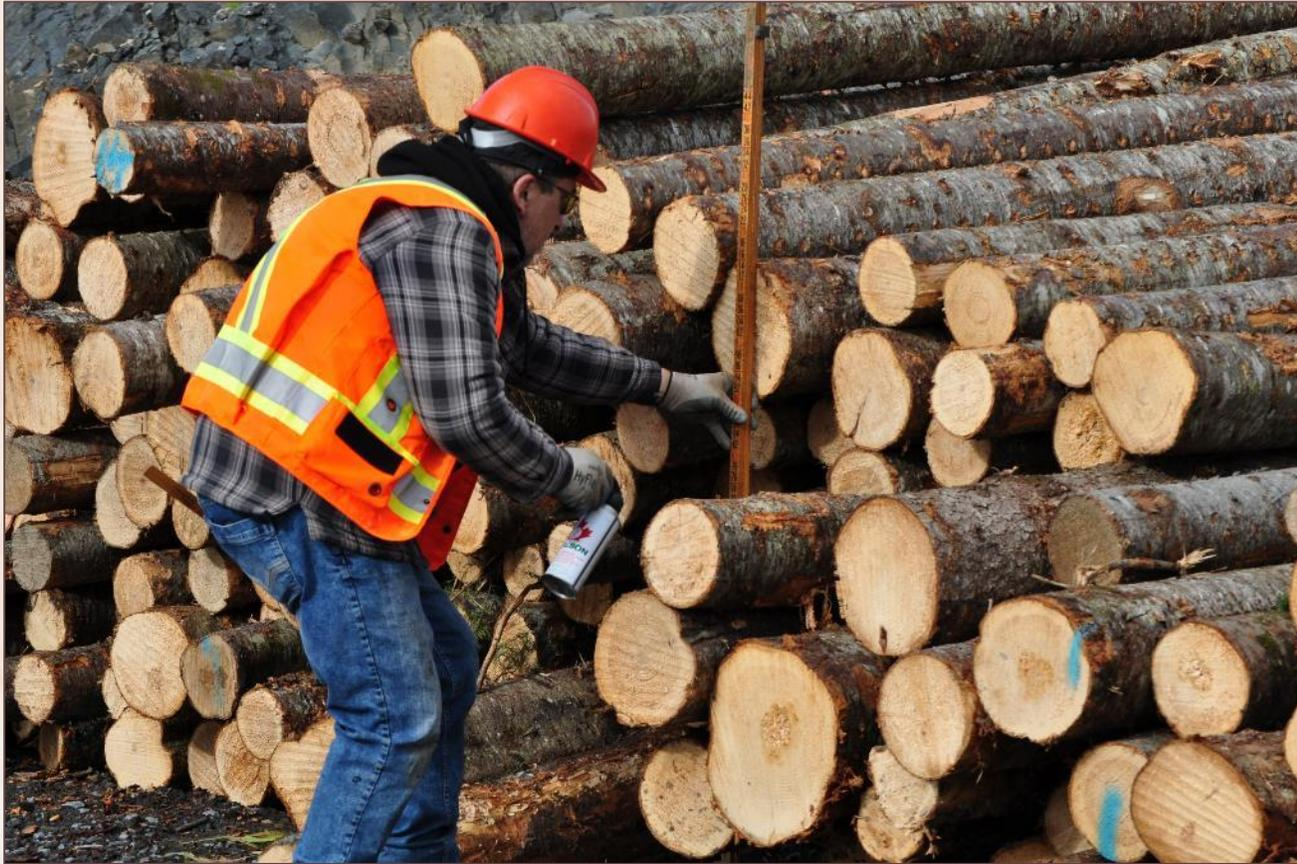
On mesure les hauteurs en mètres sur les deux faces des arrimes ou des piles afin d'obtenir la hauteur moyenne.
