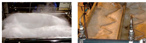
FIGURE 3. EFFICACITÉ DU PROTOTYPE À CONTRÔLER LA MOUSSE DANS LES CASSEROLES À P LIS AVANT (GAUCHE) ET APRÈS DÉMARRAGE DE LA CIRCULATION D'EAU (DROITE)
